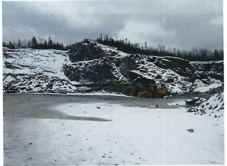
IMG_4730.JPG Image 6. Pelle mécanique art.23-24 qui prélève du matériel et remplit la chargeuse sur roues
