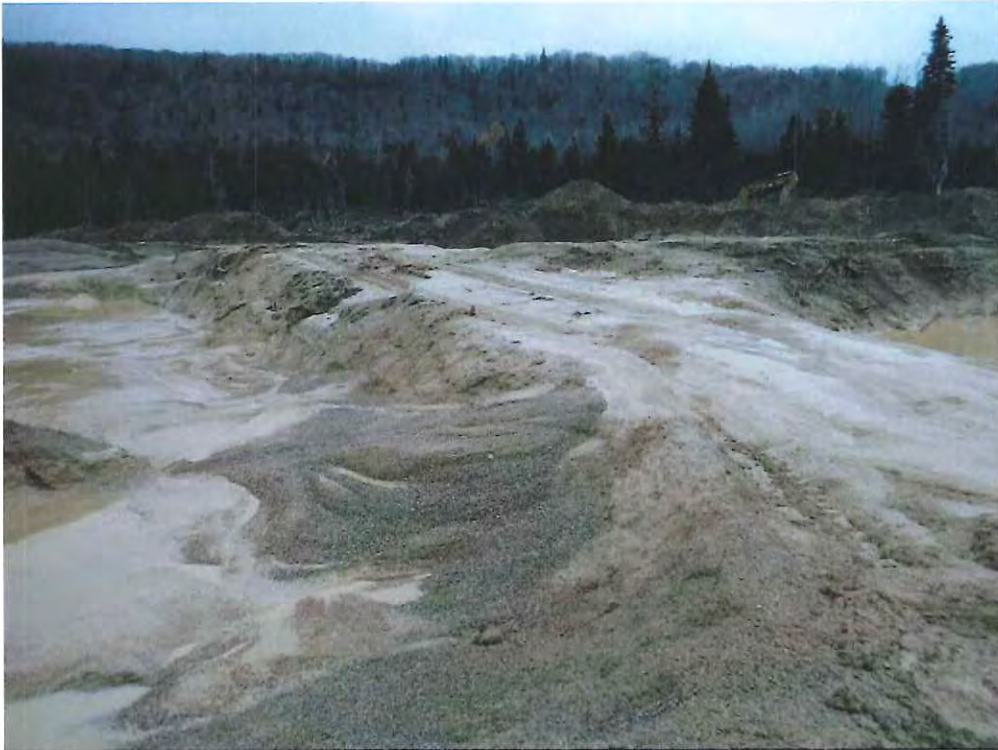
Image 22: Eaux boueuses provenant du lavage des agrégats
