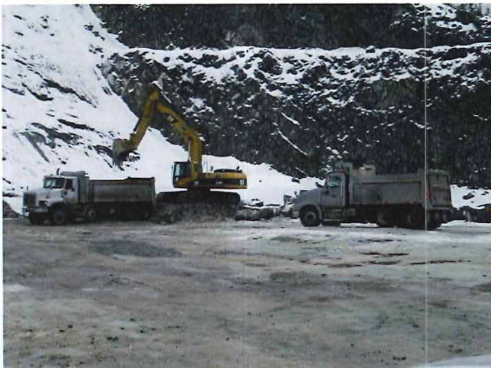
IMG_4733.JPG Image 9. Pelle mécanique art.23-24 qui prélève du matériel et remplit deux camions dix roues identifiés Gervais Dubé.
