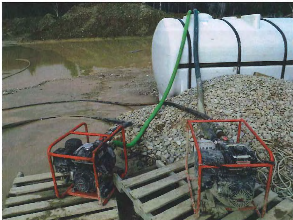
Image 24: Pompes d'alimentation du tamis
